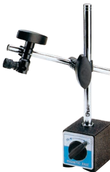
Supporto portacomparatore magnetico a chiavetta , base magnetica con superfici di appoggio piana e a V, attacco comparatore Ø 8 mm, forza trazione 60 kg, raggio d'azione 340 mm.
