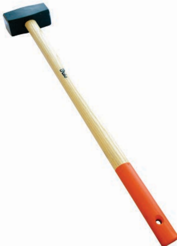
5081 Mazza a coppia con testa in acciaio temperato con battenti piani e spigoli smussati; manico in legno.
