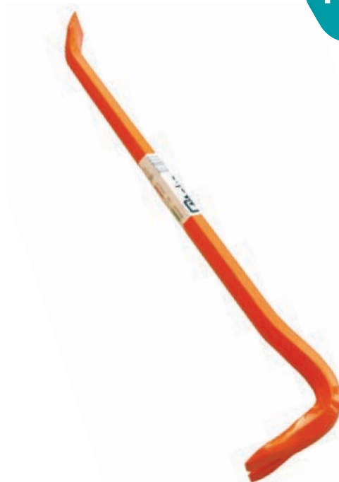
5085 Leverino per carpentiere a sezione esagonale, con leva e levachiodi in acciaio temperato e apposita curvatura nelle zone attive. Verniciatura a polvere epossidica.
