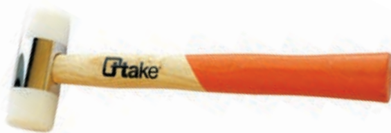
5076 Mazzuola con tasselli intercambiabili in materiale plastico (poliuretano), corpo in acciaio al carbonio e manico in legno. UNI 7784.
