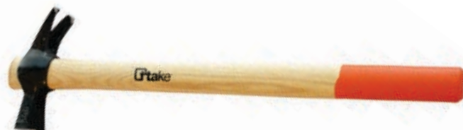
5087 Martello per carpentieri con testa in acciaio temperato a induzione, disponibile nella versione con magnete fermachiodi o senza magnete, manico in legno.
