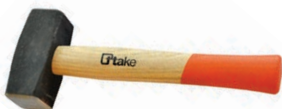
5080 Mazzetta per muratori e minatori. Doppia testa piana quadrata in acciaio temperato, esecuzione verniciata, manico in legno. UNI 7777 - DIN 6475.
