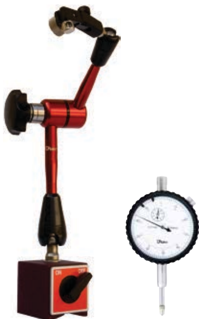
Kit supporto magnetico snodato porta comparatore (forza trazione 80 kg, raggio d'azione 340 mm), completo di comparatore di precisione (Ø 58 mm, corsa 10 mm, risoluzione 0,01, scala circolare 0÷50÷100).
