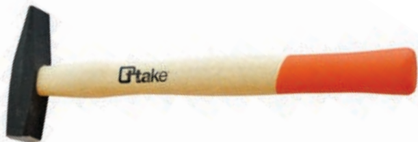
5082 Martello per meccanici , modello tedesco. Testa piana quadra in acciaio temperato e manico in legno. DIN 1041.
