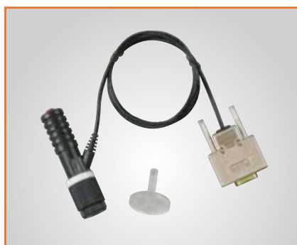
Dispositivo di impatto HLDC UD-412 Utilizzato per le pareti interne dei cilindri, l'impugnatura è corta per consentire il posizionamento interno.
