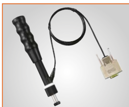
Dispositivo di impatto HLD+15 UD-413 Utilizzato per pezzi concavi come denti degli ingranaggi, cuscinetti a sfera, ecc.
