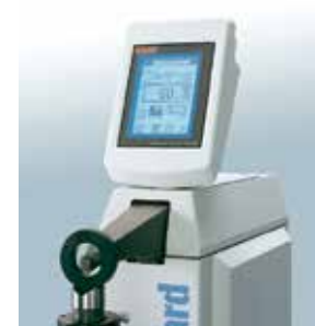
Prova di durezza su superfici interne
