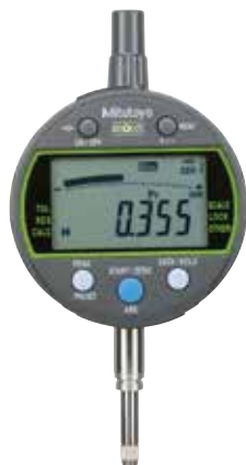
Memorizzazione del picco: Misura di MAX/MIN/RANGE (valore run-out)
