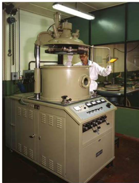
▲ Macchina sotto vuoto per la metallizzazione degli specchi con deposito di uno strato di pochi millesimi di alluminio polverizzato per ottenere la loro superficie riflettente.
