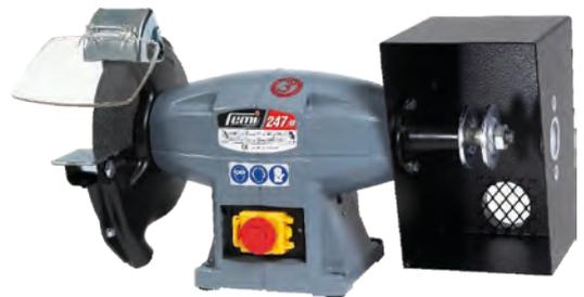
**Smerigliatrice combinata 247/M**, motore ad induzione trifase 850W dotato di protezione termica di sicurezza (per motori > 500 W); interruttore START-STOP con funzione antiripristino di sicurezza e fungo di emergenza lucchettabile; Ø mola 200x25x20 mm, Ø spazzola 200x25x16 mm, 2800 giri/minuto; peso 16 kg; completa di mole, spazzola non compresa.
