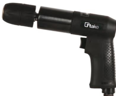
**Trapano pneumatico non reversibile – 13 mm. Velocità libera:** 500 giri/min. **Capacità mandrino:** 13 mm. **Attacco filettato:** 3/8". **Attacco aria:** 1/4" NPT. **Ø interno tubo:** 10 mm. **Consumo aria:** 113 l/min. **Lunghezza:** 228 mm. **Peso:** 1,5 kg. **Pressione aria raccomandata:** 6,2 bar.
