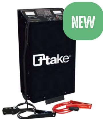
**PRO CHARGER 1000**, caricabatteria professionale 1 PH 12/24V, ideale per batterie da 160/180 Ah ed avviatore professionale con telecomando. Con 8 regolazioni di carica. **Potenza assorbita:** 2,7 kW (carica) – 12 kW (avviamento). **Corrente effettiva 12V:** 88A (carica) – 600A (avviamento). **Corrente effettiva 24V:** 90A (carica) – 570A (avviamento). **Dimensioni:** 450x300x835 mm. **Peso:** 33 kg.
