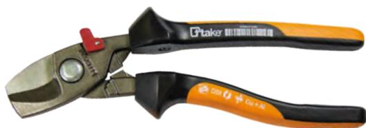
**Tagliacavi con molla**, manici ergonomici, rivestiti in materiale bicomponente, testa pulita, taglienti durezza 52 HRC, taglienti rettificati per il taglio morbido e preciso di cavi di rame e alluminio, DIN ISO 5746, molla di ritorno e fermo di arresto integrati per lavori con una sola mano, capacità taglio Ø 25mm / 70 mm<sup>2</sup>.
