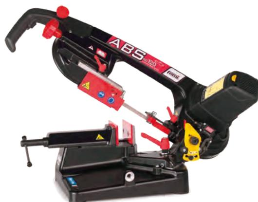
**Segatrice a nastro trasportabile ABS NG120** grande versatilità, tecnologia e prestazioni; taglio max a 0° Ø 120 mm – 120x102 mm; lama bimetallica al cobalto di serie 1440x13x0,65 mm; dimensioni 900x400x520; peso 19 kg; motore 1300W.
