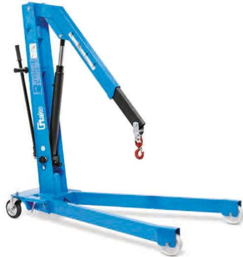
**Gru idrauliche a carrello pieghevole:** stelo rettificato e cromato; braccio allungabile in quattro posizioni; ruote posteriori girevoli; gancio girevole a 360°; pompa idraulica a due velocità; comando discesa a velocità controllata.
