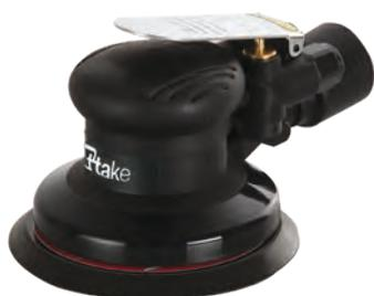
**Levigatrice pneumatica orbitale - 5 mm. Velocità libera:** 12.000 giri/min. **Ø orbitale:** 5 mm. **Ø platorello:** 125 mm. **Attacco filettato:** 5/16". **Attacco aria:** 1/4" NPT. **Ø interno tubo:** 10 mm. **Consumo aria:** 57 l/min. **Lunghezza:** 187 mm. **Peso:** 0,6 kg. **Rumorosità:** 76 dBA.
