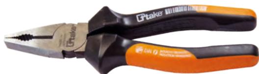
**Pinza universale**, manici ergonomici, testa pulita, taglienti durezza 60 HRC, per il taglio di fili metallici a bassa ed alta resistenza, becchi con superficie di contatto zigrinata per la presa di materiale piano e tondo e per tubi filettati, DIN ISO 5746, per impiego universale; **disponibile nelle versioni con manici rivestiti in materiale bicomponente, manici isolati 1000V VDE e manici rivestiti in resina sintetica.**
