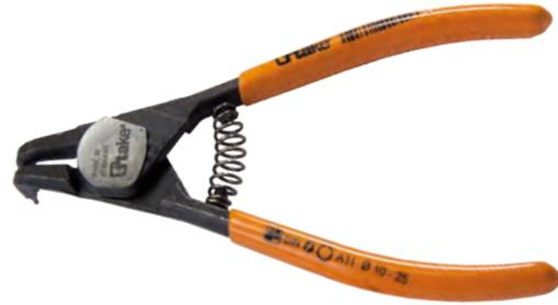
**Pinza per anelli di sicurezza esterni, con becchi piegati a 90°**, manici rivestiti in resina sintetica (pvc), testa bonderizzata nera, per il montaggio di anelli di sicurezza esterni (DIN 471 e DIN 983) su alberi da Ø 3 – 140mm, punte piegate a 90° resistenti antiscivolo, DIN ISO 5254 B.
