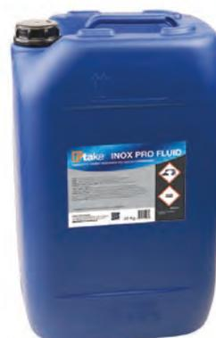
**INOX PRO FLUID**, passivante liquido a base di Acido Nitrico conforme alle ASTM A380, ideale per aumentare la resistenza alla corrosione e per garantire, dopo un adeguato decapaggio, il ripristino del film passivo di ossido di cromo, tipico degli acciai inossidabili della serie 300. Può essere impiegato anche dopo il trattamento di elettrolucidatura per togliere eventuali macchie formatesi. Si utilizza normalmente ad immersione in vasche di PP, PVC, inox, o a spruzzo (con pompa spray).
