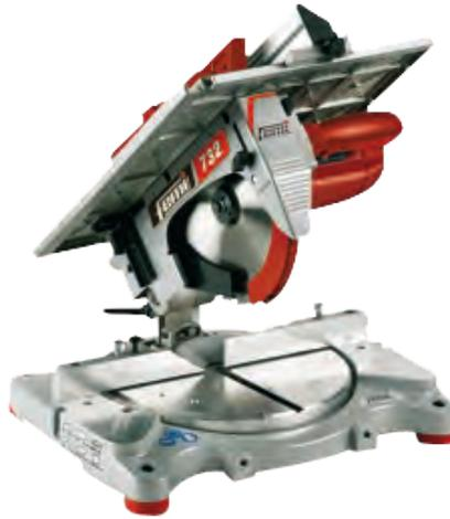
**Troncatrice circolare per legno 732**, lama Ø 254 mm, ottima trasportabilità, potente motore universale 1550W, taglio max 0° mm 162l - 78h; peso 14,5 kg; struttura interamente in alluminio pressofuso.
