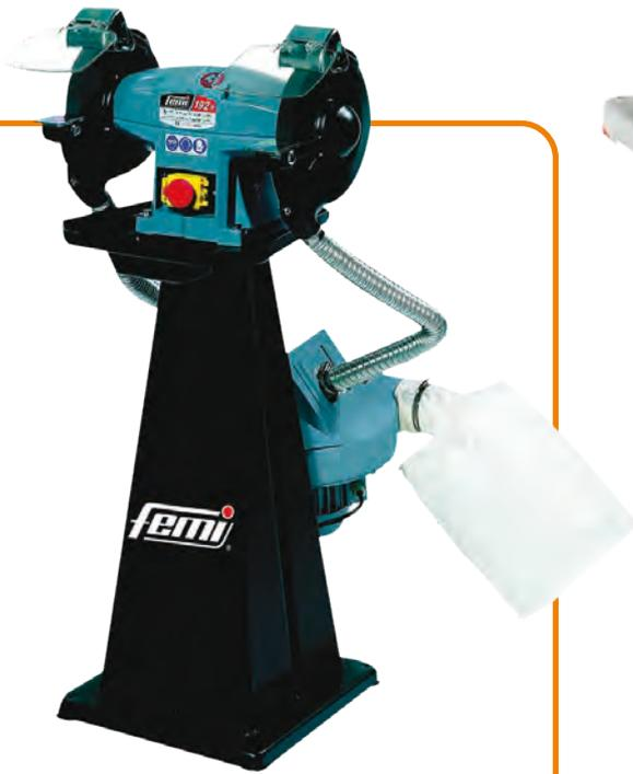
**Smerigliatrice ecologica a doppia mola 192/M**, motore elettrico trifase 850W dotato di protezione termica di sicurezza (per motori > 500 W); corpo maggiorato e grande robustezza; impianto di aspirazione integrato di serie; completa di basamento con vaschetta acqua asportabile, Ø mola 200x25x20 mm, 2800 giri/minuto; peso 38 kg; completa di mole.
