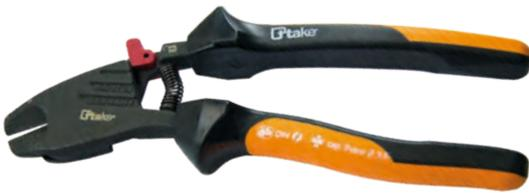
**Tronchese a doppia leva**, manici ergonomici rivestiti in materiale bicomponente, snodo innovativo e duraturo con doppia leva di precisione assistita, taglienti durezza 64 HRC, tagliente robusto e duraturo per il taglio sicuro e preciso di fili metallici a bassa ed alta resistenza e per filo armonico, molla e fermo di chiusura integrati per lavori con una sola mano, DIN ISO 5743.
