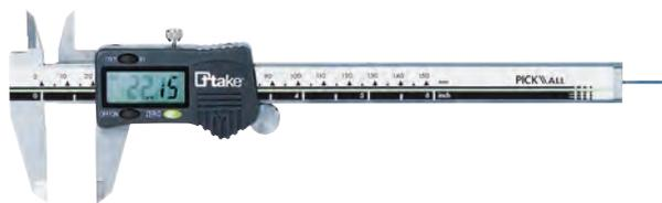
**Calibro a corsoio digitale con display a cristalli liquidi LCD**, accensione e spegnimento con pulsante e automatico, conversione mm/pollici, azzeramento in qualsiasi posizione, bloccaggio a vite, risoluzione 0,01.
