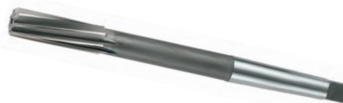
**Alesatori in HSS-Co TA1204**, DIN 208, attacco conico, tolleranza H7, elica sinistra a 5° adatti all'alesatura di tutti i tipi di materiale, a basse velocità di taglio
