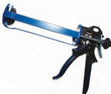
**Pistola sigillante coaxiale manuale**, con sistema di spinta ad alta resistenza, fine corsa regolabile e sistema "anti-goccia"; specifica per cartucce bi-componenti da 380/410 ml; rapporto miscelazione 10:1.
