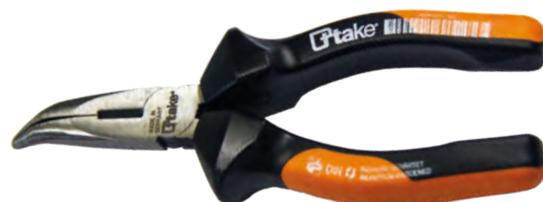
**Pinza per meccanica, a becchi mezzotondi piegati e tronchese**, manici ergonomici, testa pulita, taglienti durezza 60 HRC, becchi mezzotondi piegati a 40°, lunghi, con interni zigrinati e tronchese, DIN ISO 5745, per lavori di precisione e taglio di fili con ottima visuale dello spazio di lavoro; **disponibile nelle versioni con manici rivestiti in materiale bicomponente e con manici isolati 1000V VDE.**
