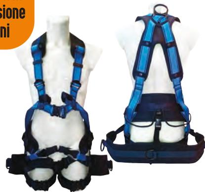
**HT GREENTOOL A XP**, imbracatura tecnica per lavori in sospensione su funi; ancoraggio dorsale a D in acciaio forgiato, ancoraggio sternale con due anelli in fettuccia, speciale fascia posteriore tipo "sella" per lavorare seduti, 5 punti di regolazione, imbracatura con cosciali tipo montagna, 3 agganci rapidi automatici, indicatori di caduta sugli ancoraggi, dorsalino in schiuma alveolare X-PAD. Conforme norme EN 361/2002, EN 358/1999, EN 813/2008.
