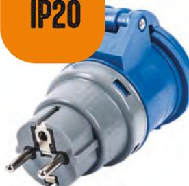
**Adattatore per uso industriale con spina Schuko e presa CEE Industrial.** Conforme alle norme CEI EN 60309-1 e CEI EN 60309-2; stabilità termica da -25°C a +70°C. Costruito in materiale ABS / nylon.
