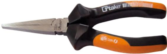
**Pinza per meccanica, a becchi lunghi**, manici ergonomici rivestiti in materiale bicomponente, testa pulita, becchi lunghi piatti con interni zigrinati, DIN ISO 5745, per lavori di presa e montaggio in spazi ristretti.
