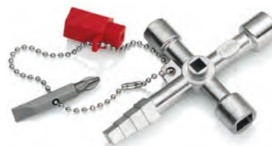
**Chiave universale "Profi-Key" per tutti i sistemi di chiusura più comuni.** Chiavi per impiantistica di riscaldamento, climatizzazione, sanitari e tecnologia abitativa (porte, finestre, scarichi riscaldamento, ecc.). Con inserto per viti: con intaglio 1x7mm e a croce PH2; catenella portachiavi; adattatore ed inserto per viti 1/4"; sede supplementare per inserto attacco 1/4". Lunghezza totale 90mm.
