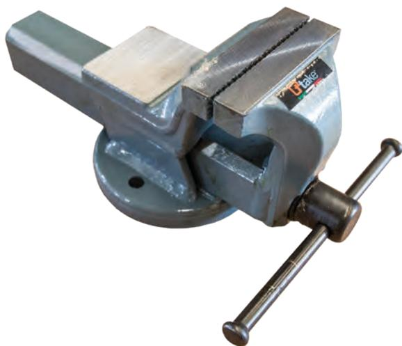
**STRONG VICE**, Morsa parallela in acciaio forgiato, specifica per lavorazioni pesanti; costruita interamente in acciaio forgiato; doppia guida prismatica; ganasce fisse zigrinate, temprate a induzione e rettificate; registrabile.
