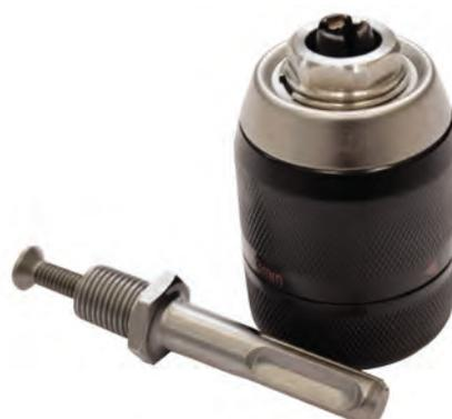
**Kit mandrino portapunte automatico in metallo con adattatore SDS Plus**, per utilizzo in avvitamento e percussione, griffe in metallo duro, con sistema di chiusura *lock system*.
