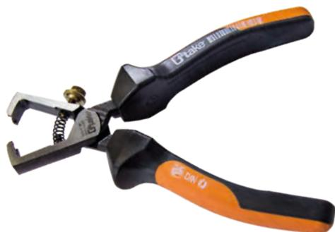
**Pinza spellafili**, manici ergonomici rivestiti in materiale bicomponente, testa pulita, per conduttori unipolari, a più fili, a fili sottili con isolamento in resina sintetica o gomma; Ø massimo cavi 5 mm, sezione 10 mm<sup>2</sup>, molla, vite di regolazione zigrinata e controdado posizionati all'interno, DIN ISO 5744.
