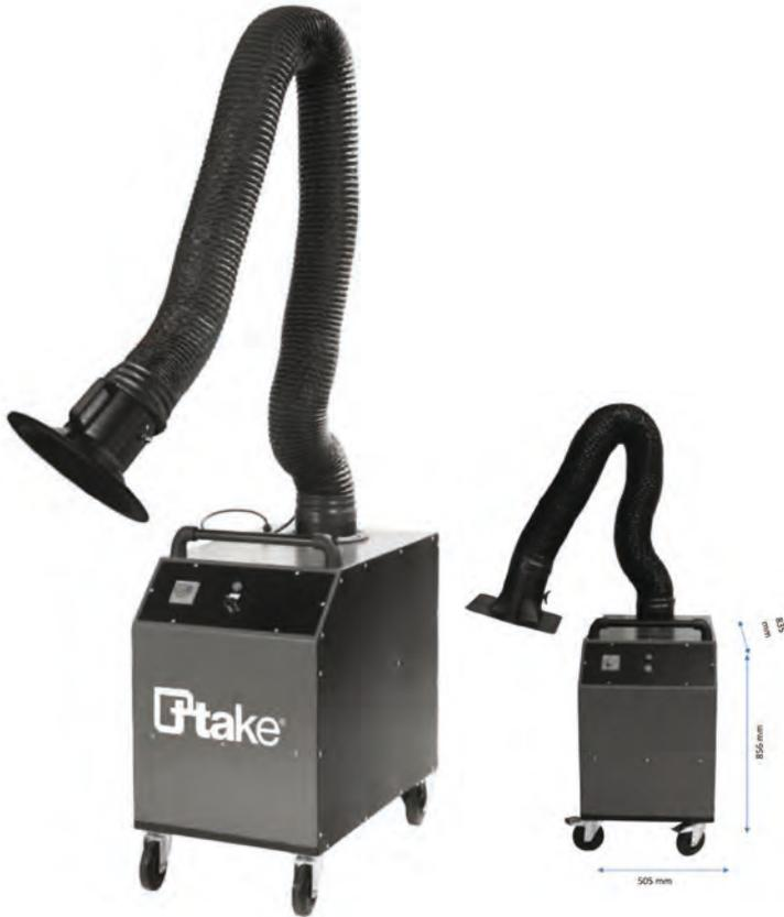
**Unità carrellata per l'aspirazione e la filtrazione di fumi di saldatura**, in impieghi poco gravosi. Equipaggiata con una batteria di 4 filtri in sequenza per filtrare meccanicamente e deodorare il fumo aspirato; braccio articolato da 3mt - Ø 160mm incluso; capacità di filtrazione 95%; portata massima 1.400 m<sup>3</sup>/h; superficie filtrante 1,03 m<sup>2</sup>; motore 1,5 HP 400V 50 Hz peso 65 kg. Agile, maneggevole e performante.
