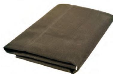
**Coperte di saldatura STRONG**, in panno di fibra di vetro (testurizzata), con pesante rivestimento in PU e grafite su due lati. Struttura molto pesante e resistente (1.100 gr/m<sup>2</sup>). Adatte per utilizzo in orizzontale, per saldature pesanti e lavorazioni a temperature elevate. Resistenti alla temperatura fino a 900°C massimo.
