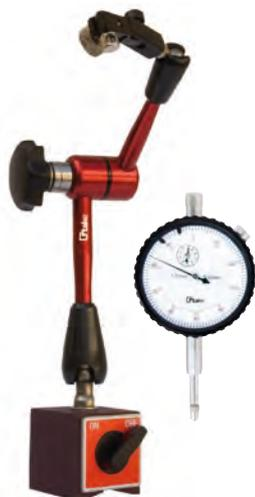
**Kit supporto magnetico snodato** porta comparatore (forza trazione 80 kg, raggio d'azione 340 mm), completo di comparatore di precisione ( $\varnothing$  58 mm, corsa 10 mm, risoluzione 0,01, scala circolare 0÷50÷100).
