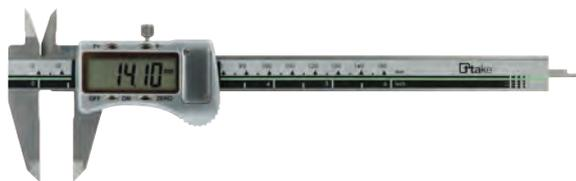
**Calibro a corsoio digitale con cassa in metallo**, becchi e punte con inserti in metallo duro. Bloccaggio a vite. Accensione e spegnimento con pulsante. Conversione mm/pollici; risoluzione 0,01.
