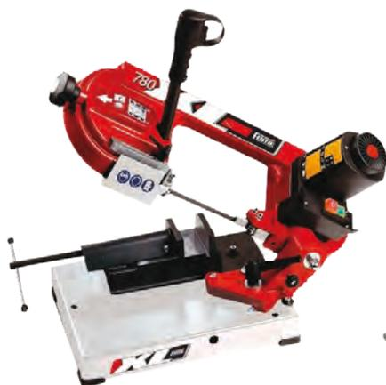
**Segatrice a nastro trasportabile 780XL** pratica e leggera, adatta ad ogni utilizzo; taglio max a 0° Ø 105 mm – 105x93 mm; peso 17 kg; lama 1330x13x0.65 mm; motore 850W.
