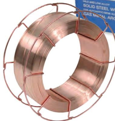
**Filo pieno ramato** per la saldatura sotto protezione di gas CO<sub>2</sub> o miscela di Ar/CO<sub>2</sub> di acciai al carbonio, acciai al manganese e similari, anche a grana fine. Caratterizzato da elevato rendimento, buona operatività anche in posizione, bassa emissione di spruzzi, ridotta quantità di silicati ed eccellente estetica del cordone.
