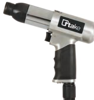
**Martello pneumatico. Colpi al minuto:** 2.600. **Corsa pistone:** 73 mm. **Ø pistone:** 10,2 mm. **Attacco aria:** 1/4" NPT. **Ø interno tubo:** 10 mm. **Consumo aria:** 113 l/min. **Lunghezza:** 211 mm. **Peso:** 2,2 kg. **Pressione aria raccomandata:** 6,2 bar.
