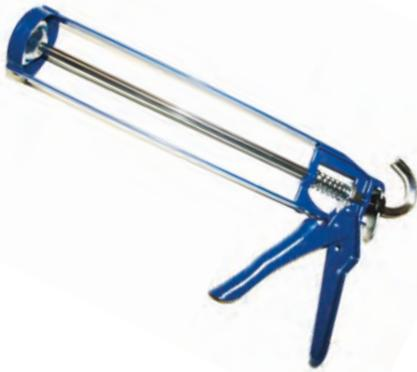
**Pistola sigillante a stelo leggera**, con asta di spinta da 8 mm, piattello bullonato, sistema di spinta ad alta resistenza e sistema "anti-goccia"; specifica per tutti i tipi di sigillanti e siliconi in cartuccia.
