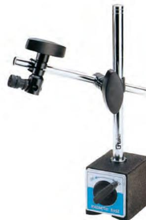
**Supporto portacomparatore magnetico a chiavetta**, base magnetica con superfici di appoggio piana e a V, attacco comparatore  $\varnothing$  8 mm, forza trazione 60 kg, raggio d'azione 340 mm.
