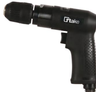
**Trapano pneumatico non reversibile – 10 mm. Velocità libera:** 2.200 giri/min. **Capacità mandrino:** 10 mm. **Attacco filettato:** 3/8". **Attacco aria:** 1/4" NPT. **Ø interno tubo:** 10 mm. **Consumo aria:** 113 l/min. **Lunghezza:** 189 mm. **Peso:** 1 kg. **Pressione aria raccomandata:** 6,2 bar.
