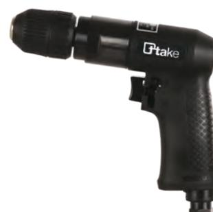
**Trapano pneumatico reversibile - 10 mm. Velocità libera:** 2.000 giri/min. **Capacità mandrino:** 10 mm. **Attacco filettato:** 3/8". **Attacco aria:** 1/4" NPT. **Ø interno tubo:** 10 mm. **Consumo aria:** 113 l/min. **Lunghezza:** 195 mm. **Peso:** 1 kg. **Pressione aria raccomandata:** 6,2 bar.
