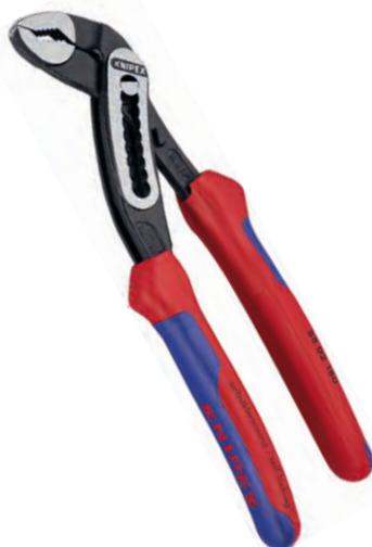
**Pinze ALLIGATOR® regolabili per tubi e dadi**, bonderizzate nere, testa pulita, manici rivestiti in materiale bicomponente, forma affusolata. In acciaio al cromo vanadio, forgiato, temperato ad olio a gradini; autoserranti per tubi e dadi; superfici delle ganasce con denti trattati con speciale tempera; durezza dei denti ca. 61 HRC; cerniera passante; con fermo di contrasto per evitare lo schiacciamento accidentale.
