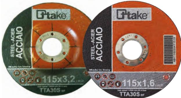
**Mole abrasive piane e a centro depresso da taglio e sbavo, per ACCIAIO:** Adatte al taglio di acciai normali, medio legati e di ghise acciaiuse, e allo sbavo di acciai con superficie di molatura estesa e lavorazione di ghise grigie. Bassa asportazione di materiale. Taglio di sezioni medio-grosse con smerigliatrici potenti (2400W), sezioni medio-piccole con smerigliatrici di bassa potenza (1800-2000W). Alta velocità di taglio e buona tenuta del disco.
