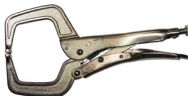
**Pinza regolabile autobloccante con ganasce a collo di cigno**, esecuzione nichelata, presa sicura di materiale piatto e sagomato, vite di regolazione e leva interna di rilascio a scatto, DIN ISO 5743, per il serraggio di pezzi e profili voluminosi con spessore fino a 40mm.
