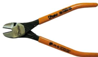
**Tronchese laterale per meccanica – tipo forte**, manici ergonomici, testa bonderizzata, taglienti durezza 64 HRC, per il taglio di fili metallici a bassa resistenza e filo armonico, con molla di apertura, DIN ISO 5749, punte taglienti resistenti per utilizzi gravosi e duraturi; **disponibile nelle versioni con manici rivestiti in resina sintetica, manici in materiale bicomponente e manici isolati 1000V, VDE.**
