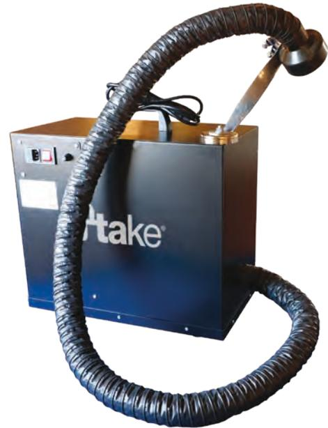
**Unità portatile per l'aspirazione e la filtrazione di fumi di saldatura leggera o a stagno**. Equipaggiata con cartuccia filtrante, carboni attivi e cavo di collegamento. Portata massima 140 m<sup>3</sup>/h; braccio articolato da 3mt - Ø 160mm incluso; capacità di filtrazione 99%; superficie filtrante 1,03 m<sup>2</sup>; motore 230V 50 Hz. Ideale per lavori a banco e di precisione.
