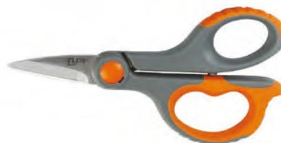
**Forbici per elettricista**, con lame in acciaio inox, spessore 3mm, durezza 50-52HRC. Impugnature ergonomiche in bimateriale (nylon + TPR). Lama microdentata finissima; doppia presa per una maggiore forza. Forbici specifiche per elettricisti.
