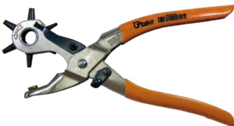
**Pinza a fustella**, manici rivestiti in resina sintetica antiscivolo (pvc), testa cromata, lucida, fustelle intercambiabili Ø 2 - 2.5 - 3 - 3.5 - 4 - 4.5 mm, molla di ritorno, autobloccante, per punzonare fori su cuoio, tessuto e materiale sintetico.
