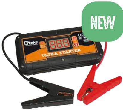
**ULTRA STARTER**, avviatore d'emergenza a supercondensatori; booster ecologico di avviamento senza batteria interna, che si ricarica automaticamente in pochi secondi. Questo avviatore di emergenza e tester batteria adotta una nuova tecnologia che utilizza i supercondensatori al posto delle normali batterie al piombo o al litio per l'avviamento dei veicoli. **Uscite:** 12V/10A. **Corrente di booster:** 700A. **Dimensioni:** 340x280x90 mm. **Peso:** 2 kg.
