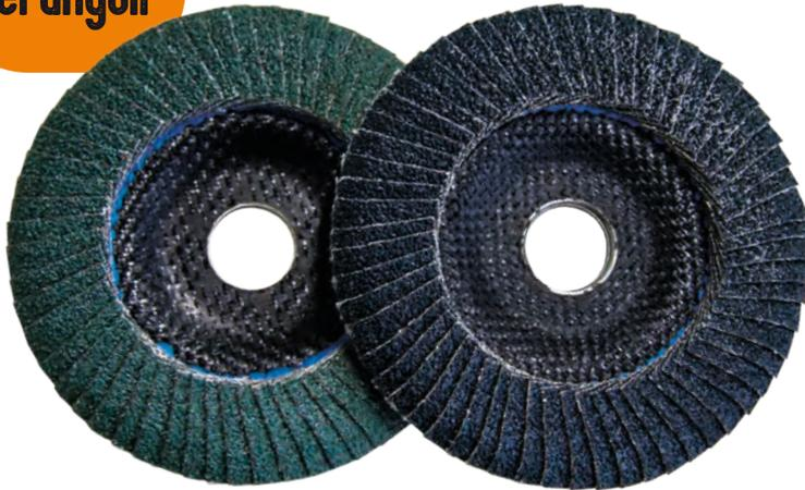
**Disco lamellare EDGE AB6700 piano,** con lamelle rivoltate e incollate sul diametro esterno del supporto in fibra, per garantire elevata resistenza e durata del bordo; ideale per la smerigliatura degli angoli e di punti di difficile accesso. Dimensioni 125x22 mm; confezioni da 20 pz.
