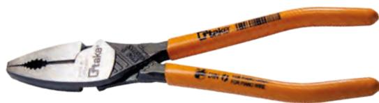
**Pinza universale con molla**, manici ergonomici, testa pulita, taglienti durezza 64 HRC, per il taglio di fili metallici a bassa ed alta resistenza, becchi con 4 punti di contatto per una presa sicura, taglienti allungati per tagli precisi, DIN ISO 5746, per impieghi gravosi e prolungati; **disponibile nelle versioni con manici rivestiti in materiale bicomponente e con manici rivestiti in resina sintetica.**
