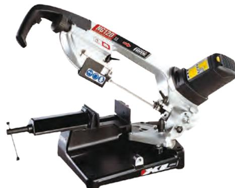
**Segatrice a nastro trasportabile NG120XL** motore 1300W con regolatore elettronico digitale di velocità, tendilama frizionato (brevetto esclusivo), taglio fino a 60° SX con blocco rapido 45° e 60°, doppio guidalama scorrevole anteriore e posteriore, taglio max a 0° Ø 120 mm, peso Kg 18, lama 1440x13x0,65 mm, NG System (rotazione contraria della lama) per una riduzione dei tempi di taglio fino al 60%
