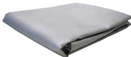
**Coperte di saldatura ALU BASIC**, in panno di fibra di vetro (a filamento), con rivestimento in PU su un lato. Leggere (460 gr/m<sup>2</sup>), adatte per utilizzo in verticale, per saldature leggere e lavorazioni a temperature non elevate. Resistenti alla temperatura fino a 550°C.
