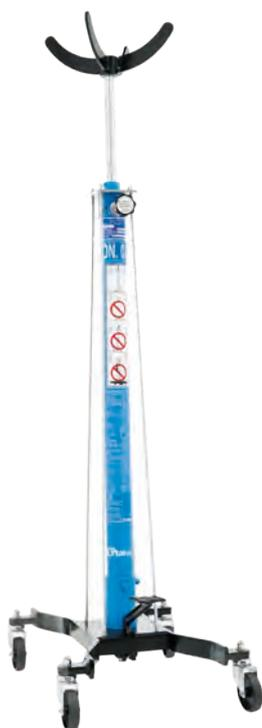
**Sollevatori idraulici da fossa:** Stelo in acciaio speciale rettificato e cromato; ruote di grandi dimensioni montate su cuscinetti per la massima manovrabilità; valvola di protezione contro i sovraccarichi; comando di discesa a velocità controllata "uomo presente".
