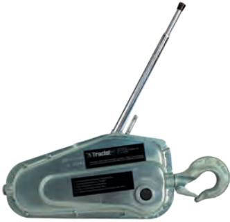
**Argano manuale mobile Tirfor® T-7** per utilizzo agricolo e forestale, completo di gancio girevole ed asta di comando; peso ridotto 7 kg; portata 750 kg. Completo di fune da 20 mt.
