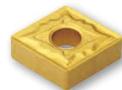
**Inserto di tornitura negativa CNMG...MX TT230;** rompitruciolo specifico per acciaio inox e super leghe con taglio dolce e bassi sforzi di taglio; TT230 qualità specifica per lavorazioni di acciaio inox a media velocità, utilizzabile anche su super leghe; eccellenti prestazioni per lavorazioni nelle lavorazioni a bassa velocità.
