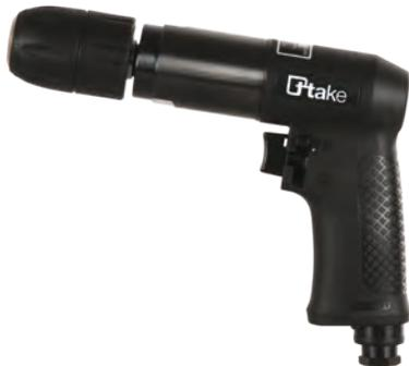
**Trapano pneumatico reversibile – 13 mm. Velocità libera:** 800 giri/min. **Capacità mandrino:** 13 mm. **Attacco filettato:** 3/8". **Attacco aria:** 1/4" NPT. **Ø interno tubo:** 10 mm. **Consumo aria:** 113 l/min. **Lunghezza:** 219 mm. **Peso:** 1,3 kg. **Pressione aria raccomandata:** 6,2 bar.
