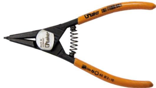
**Pinza per anelli di sicurezza esterni, manici rivestiti in resina sintetica (pvc)**, testa bonderizzata nera, per il montaggio di anelli di sicurezza esterni (DIN 471 e DIN 983) su alberi da Ø 3 – 140mm, punte diritte resistenti antiscivolo, DIN ISO 5254 A.
