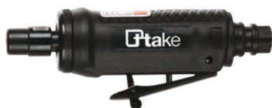
**Smerigliatrice pneumatica dritta - 6 mm. Velocità libera:** 25.000 giri/min. **Attacco quadro:** 6 mm / 3 mm. **Attacco aria:** 1/4" NPT. **Ø interno tubo:** 10 mm. **Consumo aria:** 113 l/min. **Lunghezza:** 161 mm. **Peso:** 0,4 kg. **Potenza:** 0,2 Kw. **Rumorosità:** 84 dBA. **Pressione aria raccomandata:** 6,2 bar.
