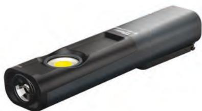
**Torcia da ispezione reclinabile**, per uso individuale, dotata di batterie Li-ion ricaricabili. Può illuminare con luce diffusa in modo uniforme e due stadi di intensità (flood), oppure in profondità (spot) con lente riflettore. Con gancio e magneti integrati nel corpo della torcia, per consentire diverse soluzioni di fissaggio. Autonomia: 3 h (300 lumen), 2 h (600 lumen). IP54.
