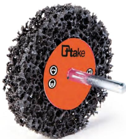
**Disco C&S con gambo**, composto da una rete di fibre in nylon impregnate con abrasivo al carburo di silicio. Molto resistente, ideale per operazioni di decapaggio e pulitura su qualsiasi materiale; gambo 6/8 mm.
