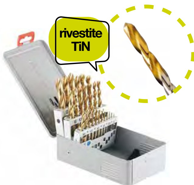
Serie di punte in HSS TA1070 , lucide, serie corta, DIN 338 Premium, rivestite TiN, 5xD, in cassetta metallica.
