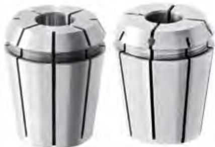
Pinza ERXG32M a tenuta del refrige- rante con OR, con quadro per maschi, max 40 bar.
