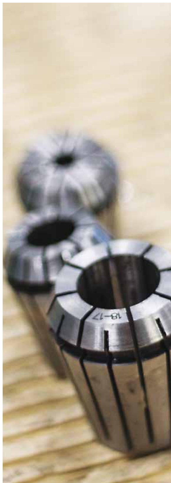
Pinza ERXG32M a tenuta del refrige- rante con OR, con quadro per maschi, max 40 bar.
