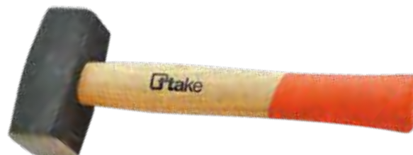
5080 Mazzetta per muratori e minatori. Doppia testa piana quadra in acciaio temperato, esecuzione verniciata, manico in legno. UNI 7777 - DIN 6475.
