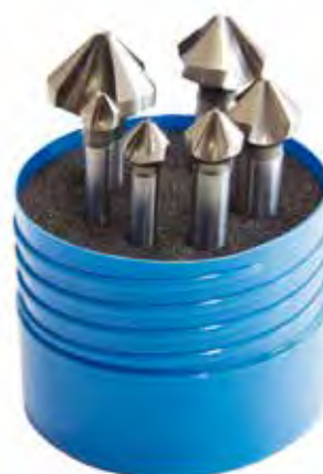
Serie di 6 svasatori a 90° TA1230 , a 3 taglienti, in HSS, DIN 335C, non rivestiti, codolo cilindrico. Composto da 1 pz. per tipo Ø 8,3 – 10,4 – 12,4 – 16,5 – 20,5 – 25.
