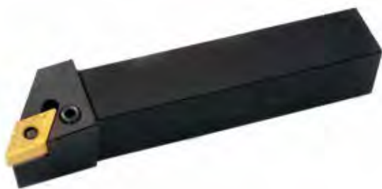
Utensile di tornitura esterna PDJN R/L TA5020 , ad inserti negativi, con bloccaggio a leva tipo P, stelo in acciaio.
