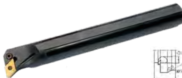
Utensile di tornitura interna A.PDUN R/L TA6020 , ad inserti negativi, con lubrificazione interna, bloccaggio a leva tipo P, stelo in acciaio.
