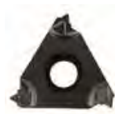
Set di 10 inserti per filettatura esterna metrica 16 ER "E" TF 125, composto da 2 inserti per tipo passo 1,00 - 1,50 - 2,00 - 2,50 - 3,00. Ideali per filettature di acciai al carbonio, acciai bonificati e inossidabili.
