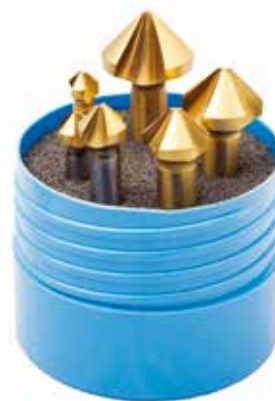
Serie di 6 svasatori a 90° TA1231 , a 3 taglianti, in HSS, DIN 335C, rivestiti TiN, codolo cilindrico. Composto da 1 pz. per tipo Ø 8,3 – 10,4 – 12,4 – 16,5 – 20,5 – 25.
