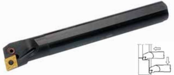
Utensile di tornitura interna A..PCLN R/L TA6010 , ad inserti negativi, con lubrificazione interna, bloccaggio a leva tipo P, stelo in acciaio.
