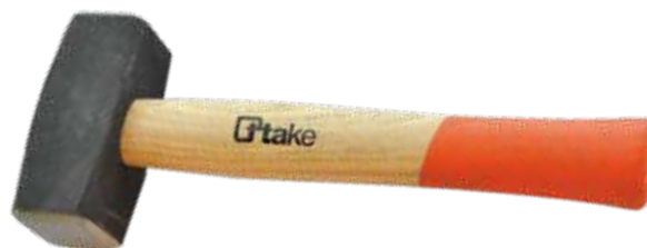
5080 Mazzetta per muratori e minatori. Doppia testa piana quadra in acciaio temperato, esecuzione verniciata, manico in legno. UNI 7777 - DIN 6475.
