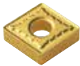
Inserto di tornitura negativa CNMG...SM TT130 ; rompitruciolo per sgrossature ad alte profondità di taglio e alti avanzamenti; adatto anche per lavorazioni con taglio interrotto e medie lavorazioni di acciai e acciai inox.
