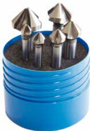
Serie di 6 svasatori a 90° TA1230 , a 3 taglianti, in HSS, DIN 335C, non rivestiti, codolo cilindrico. Composto da 1 pz. per tipo Ø 8,3 – 10,4 – 12,4 – 16,5 – 20,5 – 25.
