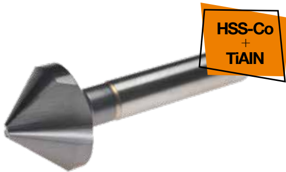
Svasatore a 90° in HSS-Co TA1241 , DIN 335 C, a 3 taglianti, rivestito TiAIN, con codolo cilindrico.
