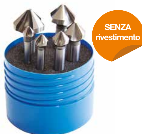
Serie di 6 svasatori a 90° TA1230, a 3 taglienti, in HSS, DIN 335C, non rivestiti, codolo cilindrico. Composto da 1 pz. per tipo Ø 8,3 - 10,4 - 12,4 - 16,5 - 20,5 - 25.
